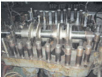
Рис. 4. Модернизация компрессора синтез-газа в производстве метанола.
