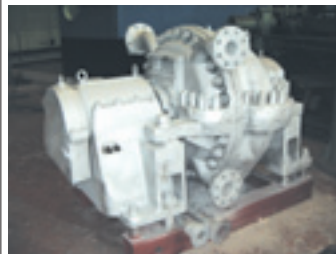
Рис. 1. Паровая турбина P-3,5-40/15-1 в производстве азотной кислоты после модернизации НПФ «Энтехмаш».
