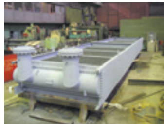
Рис. 2. Промежуточный аппарат воздушного охлаждения (АВО) с оребренными трубками импортного центробежного компрессора, изготовленный НПФ «Энтехмаш».
